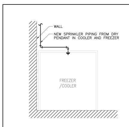
DRY PENDANT SPRINKLER A M3 SCALE: NOT TO SCALE COOLER/FREEZER
