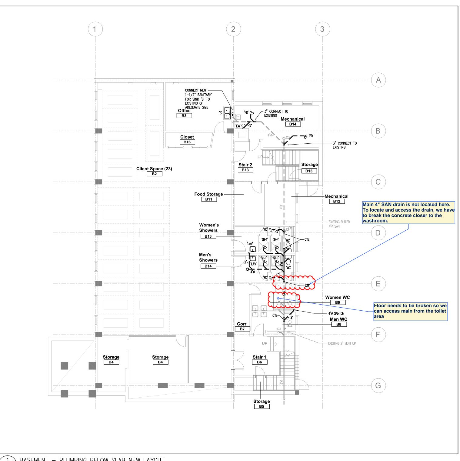
\ BASEMENT − PLUMBING BELOW SLAB NEW LAYOUT
